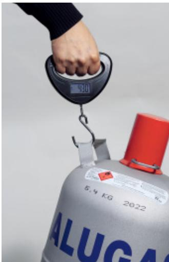
*Füllstandsmessgeräte arbeiten mit Ultraschall. Wer mit der Wiegemethode den Inhalt prüft, muss das aufgedruckte Tara-Flaschengewicht abziehen.*
