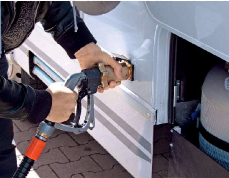
*Der Camper füllt Tank oder Tankflasche direkt am Behälter oder über einen optionalen Anschluss.*
