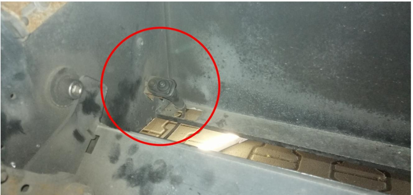
Der 2. Endschalter für das Ausfahren der Treppe ist ein Microschalter (**Endtaster2**), der über der Achse am Treppengehäuse angeschraubt ist.
