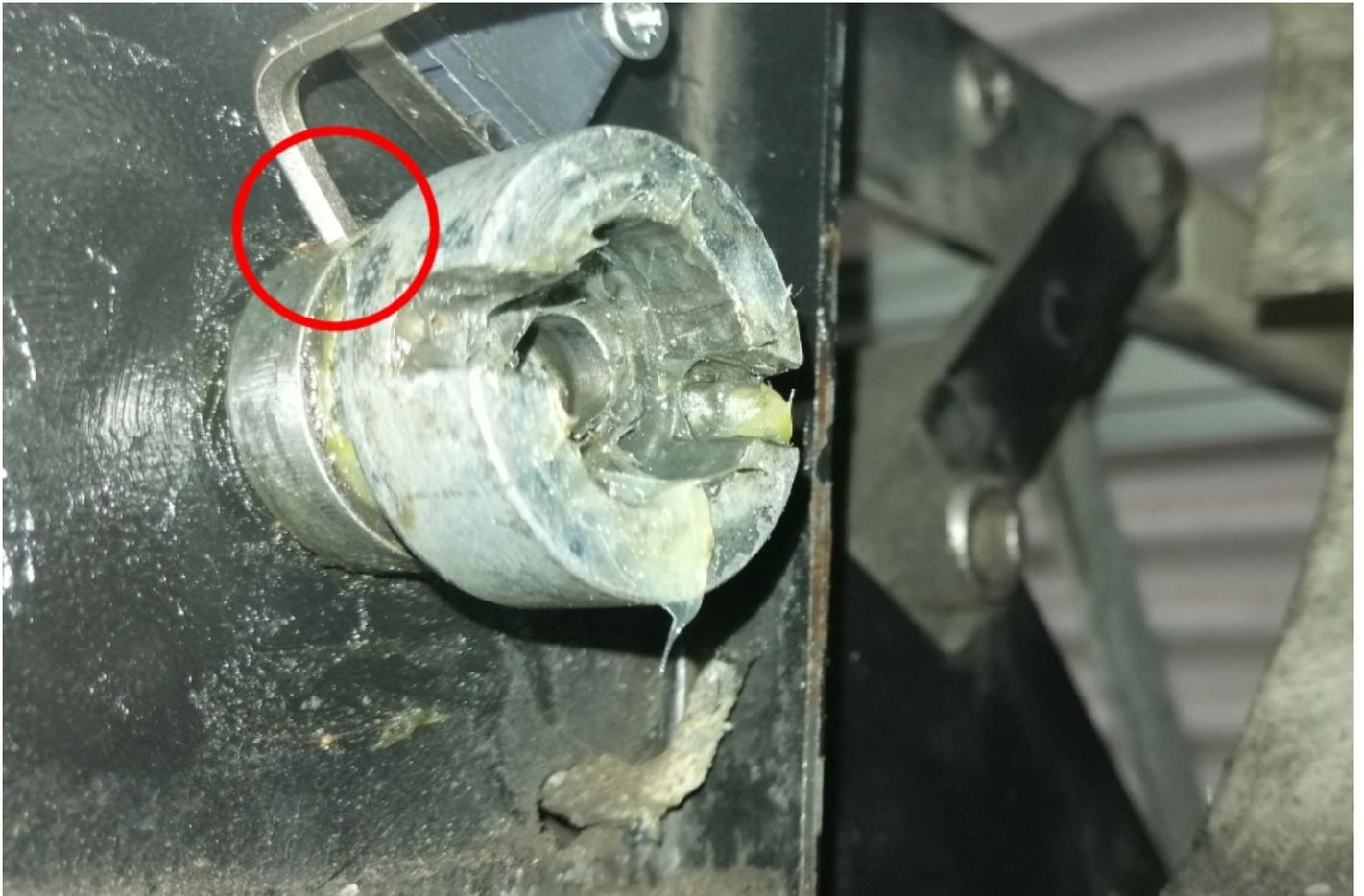
Wenn der Ring lose ist, klappt man die Treppe ganz nach unten in die oben beschriebene Endstellung und dreht den Ring mit dem Nocken so lange im Uhrzeigersinn, bis man den Endschalter2 (Microschalter) deutlich schalten hört. Man dann das auch mit einem Multimeter kontrollieren.
