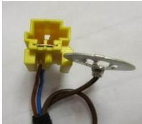
Die Flußrichtung des Stroms ist für die Funktion des Gurtstraffers unrelevant. Ob dieser erst durch die Induktivität (im Stecker 7mH) und schließlich durch den Widerstand (Zündpille mit 2 Ohm) oder umgekehrt fließt, spielt hierbei keine Rolle. Der Stecker ist phasenneutral.
