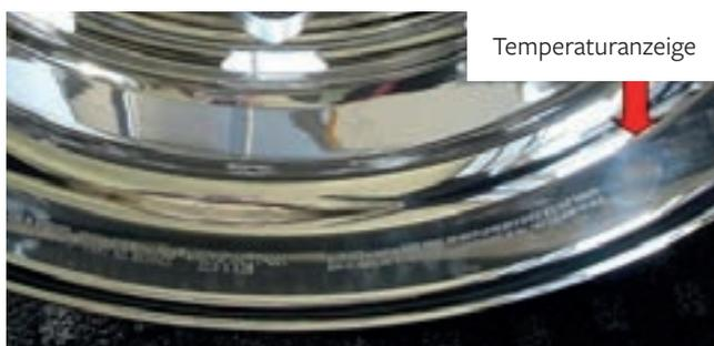
Abbildung 13-2 Hitzeindikator am Radflansch
