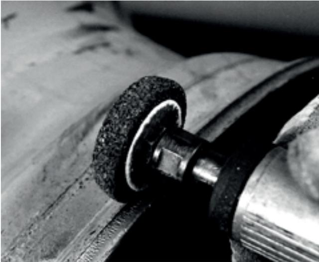
Abbildung 13-35 Schleifmaschine mit Schrupscheibe
