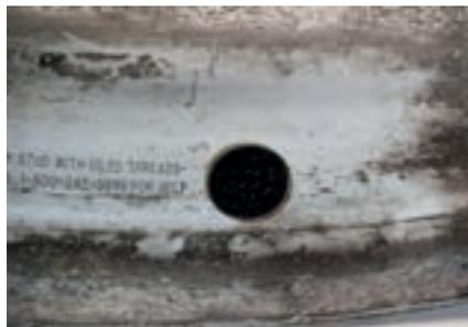
Abbildung 13-10 Verschmorter Hitzeindikator neben Rollstempel ab 2009 (Nahaufnahme)
