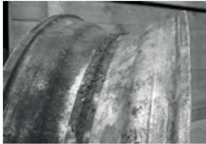
Abbildung 13-7 Verfärbung der Felge mit verschmortem Gummi
