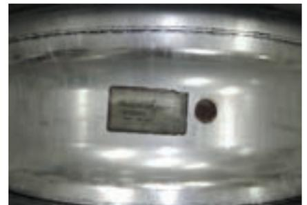
Abbildung 13-11 Verschmorter Hitzeindikator im Tiefbett innerhalb des Rades ab 2009
