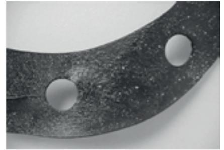
Abbildung 13-8 Verschmorter DiscMate für Alcoa-Räder oder andere Nylonschutzdichtungen
