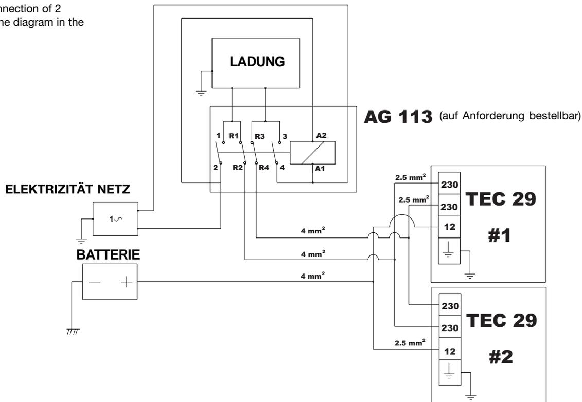
**Warnung:** Zum Schutz des Geräts gegen einen zufälligen Anschluss zur Hauptstromleitung verwenden Sie Stromwende AG113.
