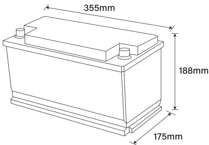
DIN-Standardabmessungen L355 \* W175 \* H188 mm
