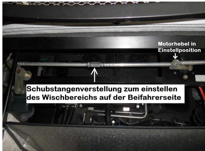
Beim Einstellen der Anlage, den Scheibenwischerarm auf der Beifahrerseite von Hand, ca. 2-3 cm von der Windschutzscheibe abheben, dadurch ist die Verstellmutter der Schubstangenverstellung ohne großen Kraftaufwand zu verdrehen.
