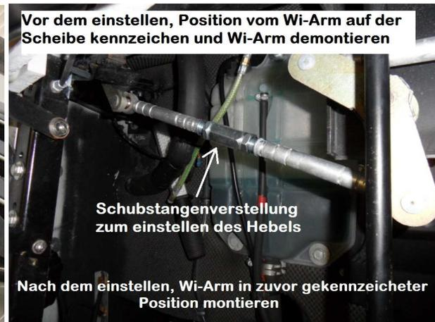
An der Schubstangenverstellung wie in Abb.9 die Kontermuttern lösen und zurückdrehen, die Länge der Schubstange so einstellen, dass zwischen Hebel und Gummipuffer ca. 1mm Spaltmaß verbleiben. Die Kontermuttern an der Verstellung festziehen und den Scheibenwischerarm in zuvor gekennzeichnete Position montieren Abb.16
