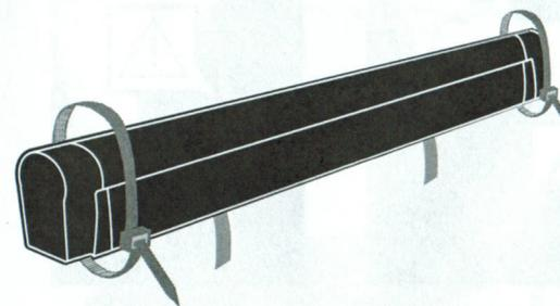
H Schützen Sie die Markise mit Schutzfolie unter den Kabelbindern
