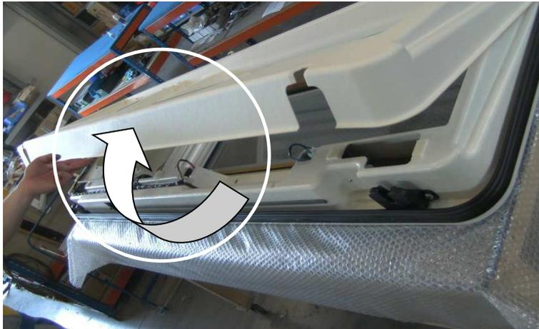
Verkleidung zur Scharnierseite hindrehen und nach oben abnehmen.
