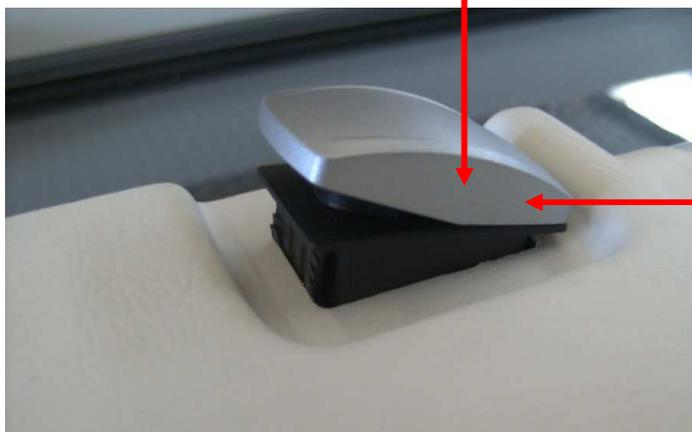
Schalter für Innenbetätigung und Innenverriegelung vorsichtig aus der Innenverkleidung herausziehen.
