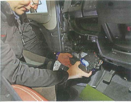
**1** Nachdem die untere Armaturenbrettverkleidung entfernt wurde, kann man den ganz links sitzenden Bordcomputer losschrauben und herunterklappen.
