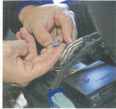
**3** Verkabelt wird das System mit Strom, dem CAN-BUS, der Zündung, den Warnblinkern und der Hupe.
