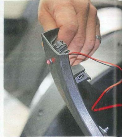
**6** Die Status-LED findet in der Armaturenbrettverkleidung links Platz und ist von außen sichtbar.
