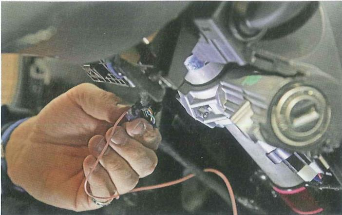
**4** Für den Anschluss an die Fahrzeughupe muss zunächst die Lenksäulenverkleidung weichen. Obacht: Die Airbagleitungen führen hier entlang und dürfen keinesfalls beschädigt werden.
