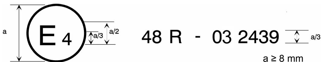
Das oben dargestellte, an einem Fahrzeug angebrachte Genehmigungszeichen besagt, dass der betreffende Fahrzeugtyp hinsichtlich des Anbaus der Beleuchtungs- und Lichtsignaleinrichtungen in den Niederlanden (E 4) nach der Regelung Nr. 48 in ihrer durch die Änderungsserie 03 geänderten Fassung genehmigt worden ist. Aus der Genehmigungsnummer geht hervor, dass die Genehmigung nach den Vorschriften der Regelung Nr. 48 in ihrer durch die Änderungsserie 03 geänderten Fassung erteilt worden ist.
