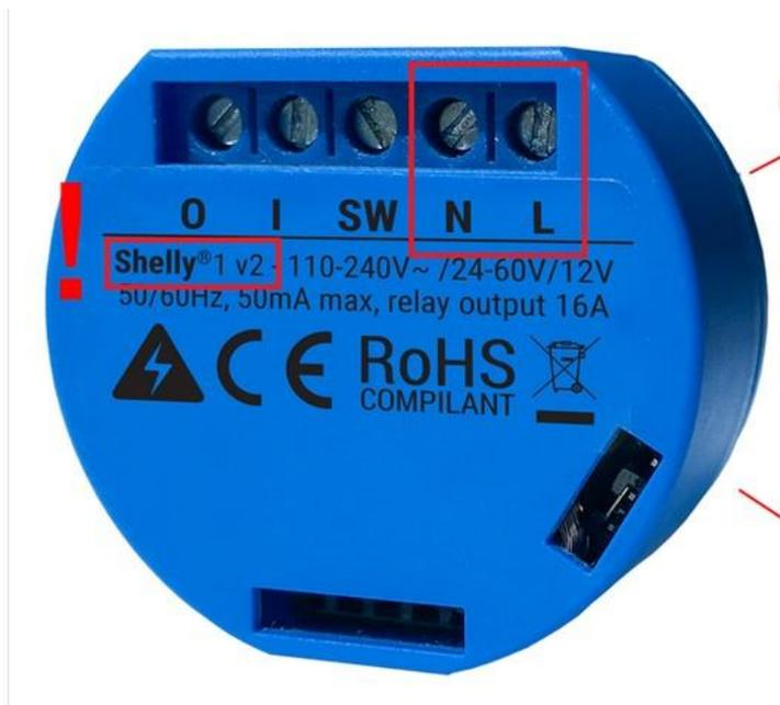
Der Shelly 1 (Version 1 v2) wird in der Konfiguration 12V eingestellt.
