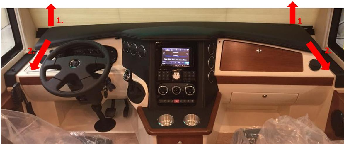
Armaturenbretthabe an der Vorderseite anheben (1) und anschließend nach hinten herunterziehen (2)
