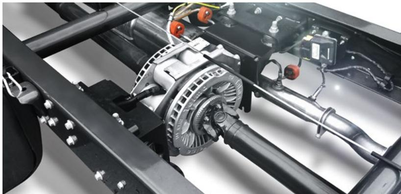
Beim Betätigen des konventionellen Bremspedals schaltet sich immer zuerst der Telma®-Retarder ein. Ohne dass der Fahrer es mitbekommt, übernimmt die Telma® **bis zu 90% aller Bremsvorgänge** und vermeidet dadurch ein Überhitzen der Betriebsbremse. So sorgt die integrierte Wirbelstrombremse, vor allem bei Bergabfahrten, für ein **Plus an Sicherheit und Komfort**, da die Betriebsbremsanlage im Notfall funktionsfähig bleibt.
