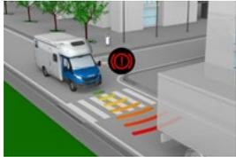
Dank einer Kombination aus Kamera und Radar erkennt der Notbrems-Assistent (AEBS) **mögliche Kollisionen frühzeitig** und bremst automatisch. So können **Unfälle bei geringeren Geschwindigkeiten gänzlich vermieden** und bei höheren Geschwindigkeiten deutlich gemildert werden.
