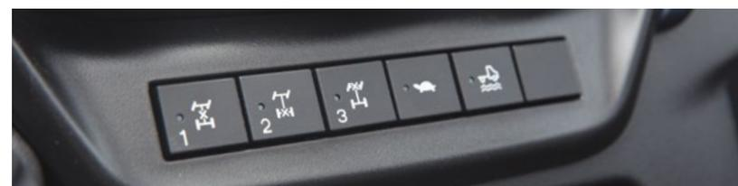
Perfekte Traktion in jeder Situation: mit **drei Differenzialsperren** an Vorder- und Hinterachse und einer **Längssperre** am Verteilergetriebe
