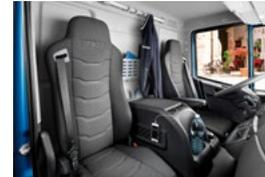
Zwei Flaschenhalter, eine 12-V-Steckdose und ein optionaler Druckluftanschluss in der Mittelkonsole
