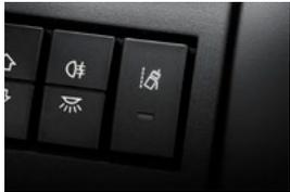
Der kamerabasierte **Warntongeber** (LDWS) warnt den Fahrer, wenn das Fahrzeug einen unerwünschten Fahrspurwechsel vornimmt.
