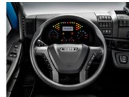
Das **Multifunktionslenkrad** mit den Bedienelementen für Audio- und Bluetooth™ fördert die Verkehrssicherheit und ermöglicht es dem Fahrer, seine Aufmerksamkeit voll auf die Straße zu richten.
