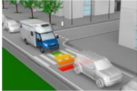
Der Stauassistent bietet die **gleiche Funktionalität wie der ACC**, allerdings für Geschwindigkeiten **unter 30 km/h**.
