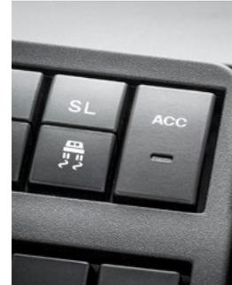
Der radarbasierte **adaptive Abstandsregeltempomat** (ACC) passt die Geschwindigkeit an den gewünschten Sicherheitsabstand zum vorausfahrenden Fahrzeug an. Mithilfe des Radars überwacht das System den Abstand und greift gegebenenfalls automatisch ein, zunächst durch Verringerung des Drehmoments, dann durch Betätigung der Motorbremse und schließlich der Betriebsbremse.
