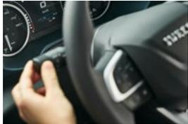
Durch Heranziehen des linken Lenkstockhebels wird wie gewöhnlich das Fernlicht aktiviert, allerdings nur im Falle eines vorausfahrenden oder entgegenkommenden Fahrzeuges.
