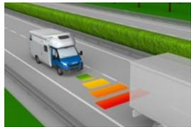
Mithilfe der Kamera und des Radars hält er die **eingestellte Reisegeschwindigkeit** und den **gewünschten Abstand zum vorausfahrenden Fahrzeug**. Wird dieses langsamer, reduziert das System automatisch die Geschwindigkeit, um den gewählten Sicherheitsabstand einzuhalten.
