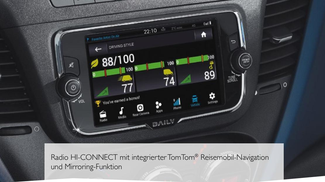
Radio HI-CONNECT mit integrierter TomTom® Reisemobil-Navigation und Mirroring-Funktion
