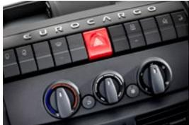
Alle wichtigen **Bedienelemente in Reichweite**, z.B. für Klimaanlage, Fahrzeugbeleuchtung und automatisiertes Getriebe
