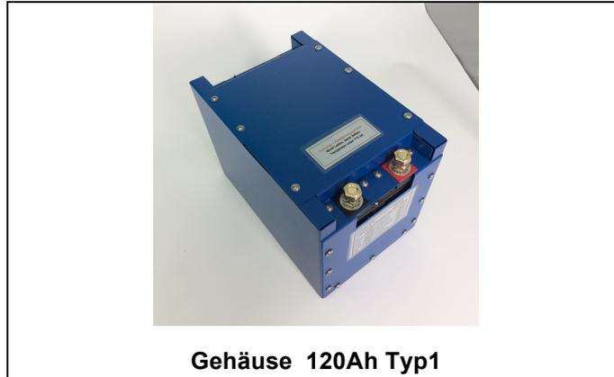
Die vierteiligen Gehäuse werden professionell und exklusiv gefertigt mit einer Toleranz von  $< +/- 1$  mm. Sie sind mit einer schlagfesten Industrie-Pulver-Beschichtung versehen. Das Gehäuse enthält alle Baugruppen, so daß keine externen Elemente verbaut werden.
