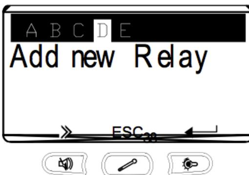
In dieser Funktion wird die Position des Relais mit der Stumm-Taste gewählt oder die Funktion mit der Beleuchtungs-Taste verlassen.
