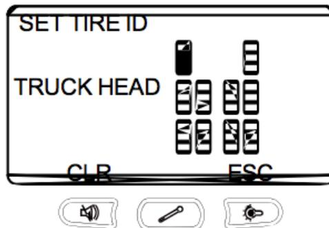
Legen Sie jetzt die Batterie in den Sensor ein und das Anzeigegerät piepst noch einmal. Zum Abschluss des Lernvorgangs drücken Sie die Reset-Taste am Relais nochmal bis die rote LED ausgeht.
