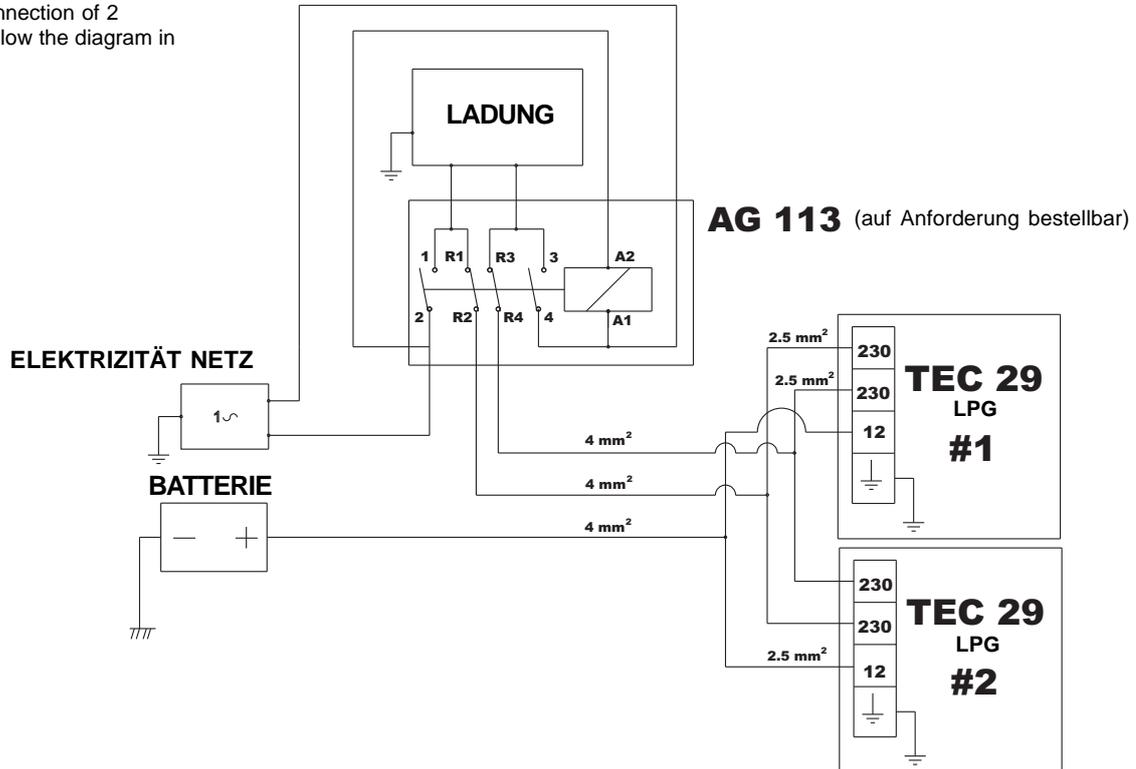
**Warnung:** Zum Schutz des Geräts gegen einen zufälligen Anschluss zur Hauptstromleitung verwenden Sie Stromwende AG113.
