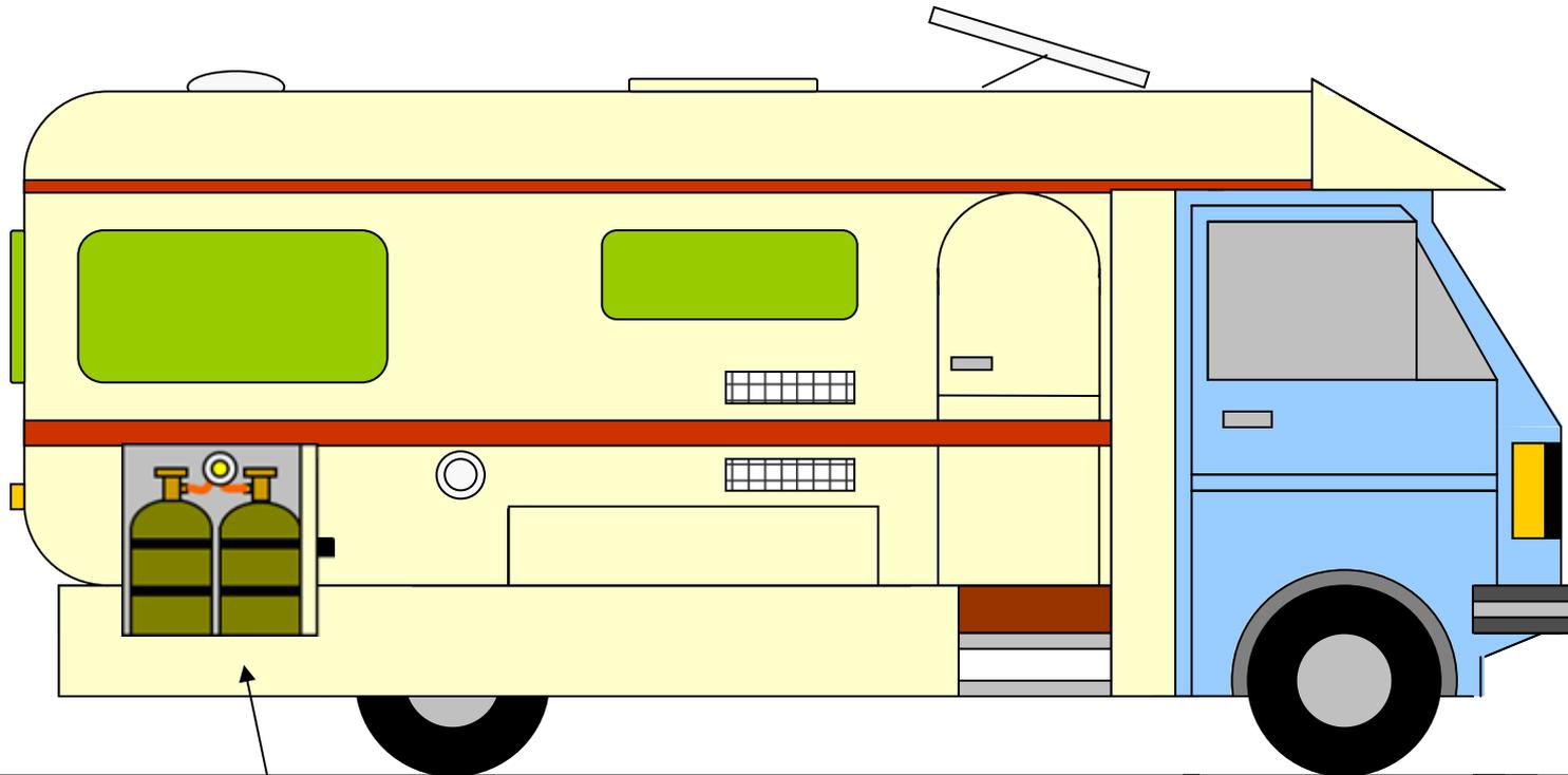
Flüssiggasflaschen über Zweiflaschenanlage (optional) angeschlossen und durch leicht lösbare Haltegurte befestigt
