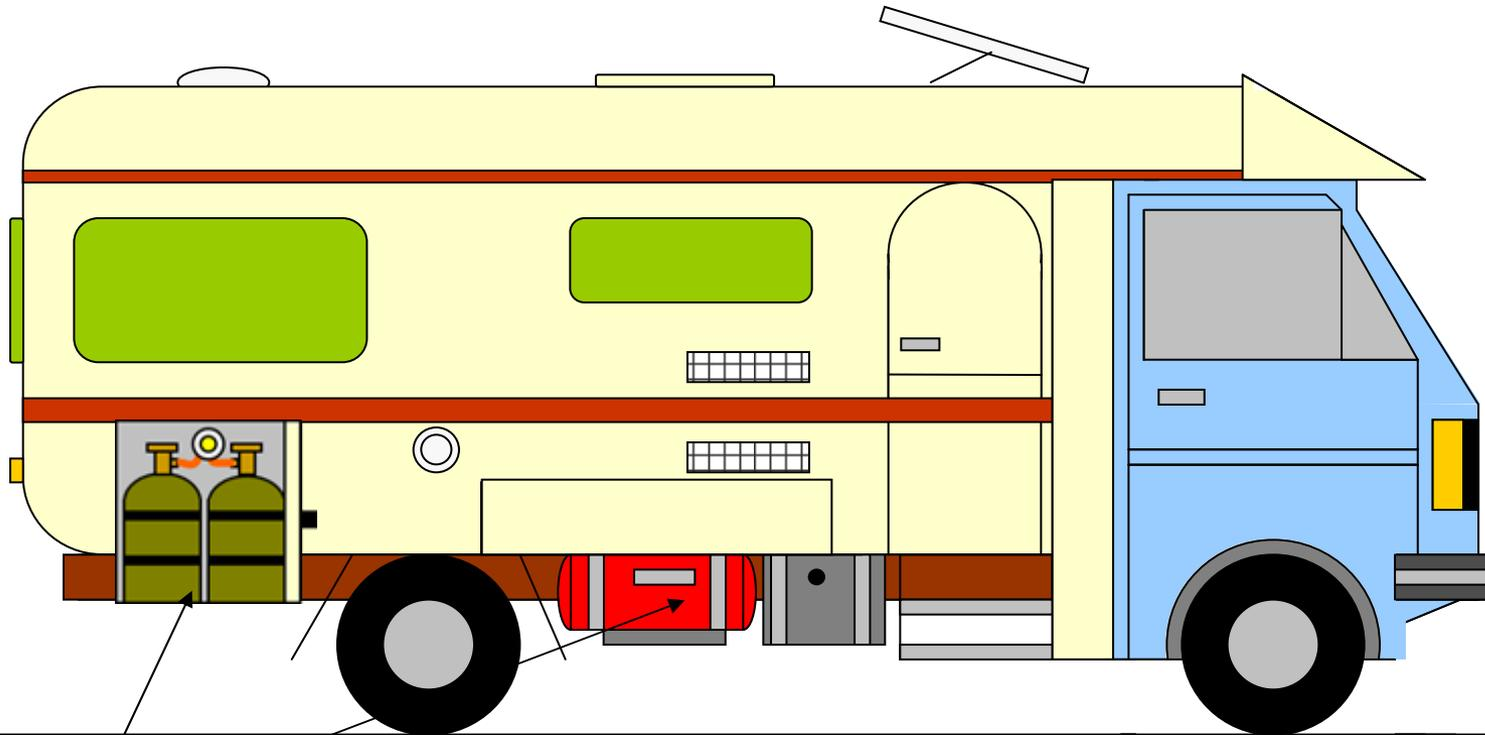
Wenn ein Flüssiggastank und Flaschen eingebaut sind, müssen diese über ein manuelles Umschaltventil miteinander verbunden werden, keine automatische Umschaltung zwischen Tank und Flasche(n) erlaubt !
