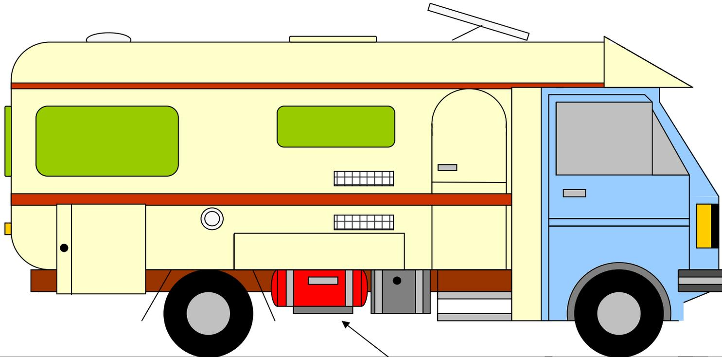
Beschaffenheit des Tanks, Ausrüstung und Befestigung nach ECE R-67, Kraftaufnahme von 20 G in Längs- und 8 G in Querrichtung, hier am Längsträger des Chassis befestigt, Berücksichtigung der ECE R-122 für Heizanlagen in Fahrzeugen !
