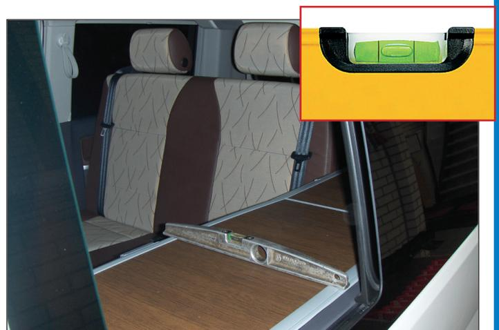
11. Richten Sie das Auto nun in Querrichtung horizontal aus, und drücken Sie erneut auf **SERVICE**, um die Werte zu speichern. Das Bediengerät gibt ein langes Tonsignal aus und alle Lampen erlöschen.
