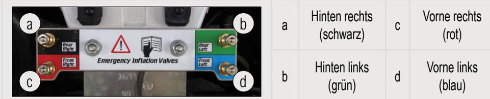
**i** Die Ventile sind so angebracht, dass sie leicht der entsprechenden Seite zugeordnet werden können. Zudem sind die Ventile gekennzeichnet.
