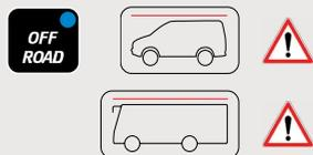
Mit der Taste
