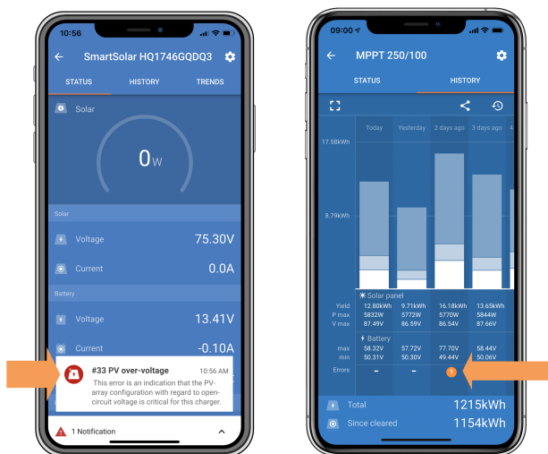
Ein aktiver Fehler und ein historischer Fehler.
